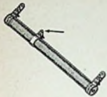
DRAADGEWONDEN WEERSTAND, met verplaatsbare aflaklem.
